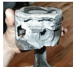
Obr. 3 Píst ze zadřeného motoru
