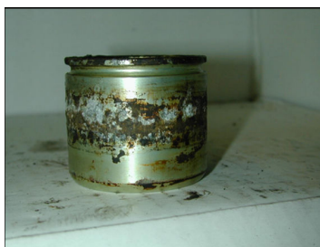
Obr. 7 Píst silně napadený korozi
