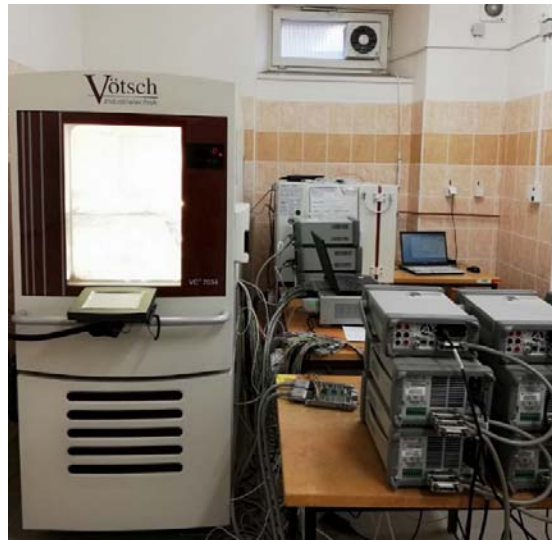
Obr. 2 Klimatická komora s měřicí aparaturou
